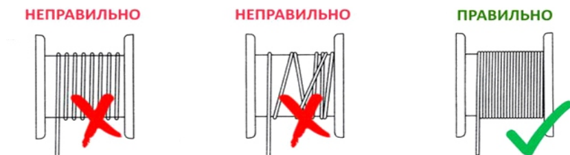
Рисунок 5. Намотка троса на катушку.
