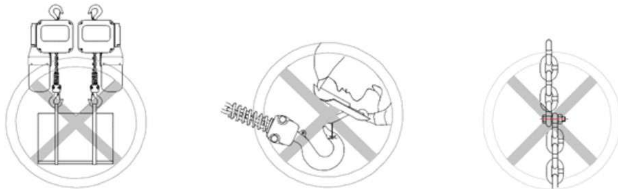
Рисунок 9. Правила использования тали.
