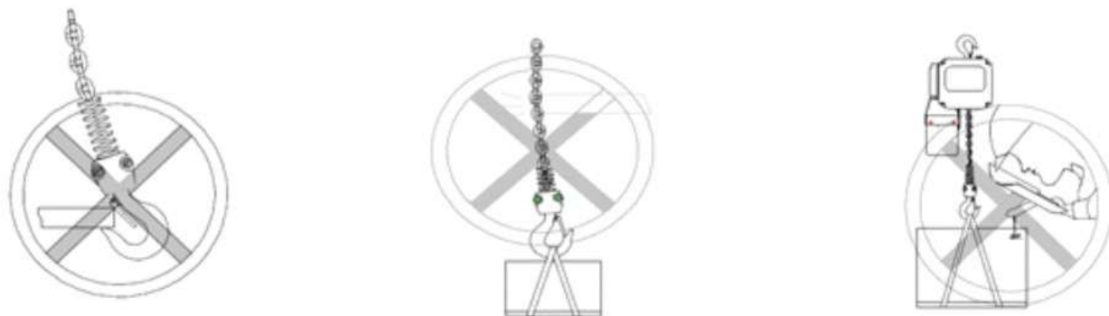
Рисунок 7. Правила использования тали.
